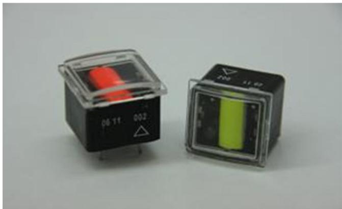
Электромеханический индикатор (ЭМИ) относится к электромагнитным устройствам отображения визуальной информации пассивного типа и может быть использован в матричных табло коллективного пользования при разработке и изготовлении управляемых дорожных знаков, информационных табло, в системах аварийной защиты, системах регистрации аварийной информации, на диспетчерских щитах, в железнодорожном транспорте, связи, коммунальном хозяйстве, охране и сферах человеческой деятельности.
